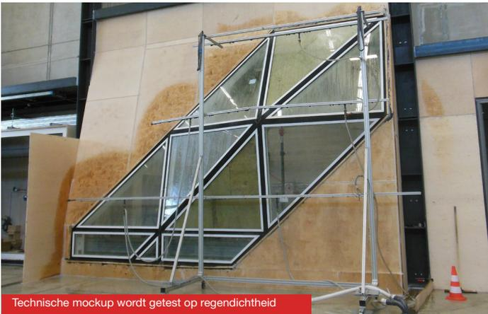
Technische mockup wordt getest op regendichtheid
